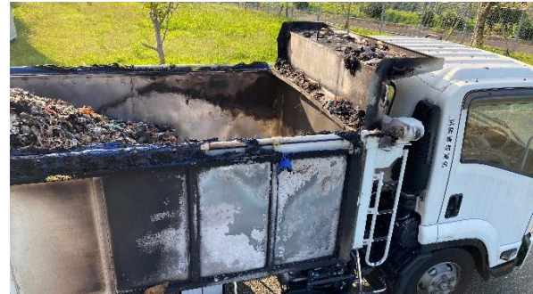
【ダンプ荷台の焼損状況】
