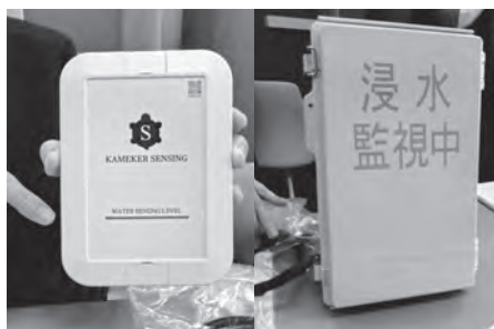
町内3箇所に設置される浸水検知センサー
