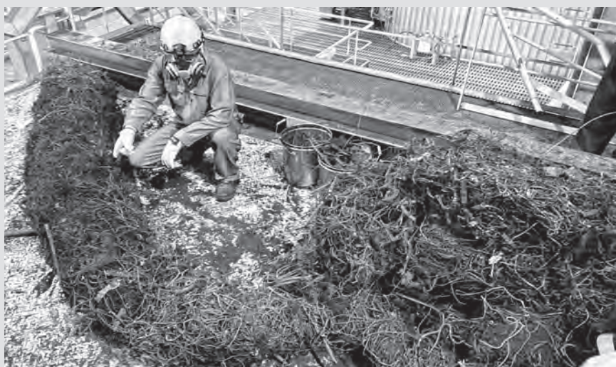
▲焼却炉から取り除かれた金属の塊で、大きさが直径40 cm、長さが13 mになったもの
