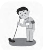
水道メーターや止水栓に音聴棒を当てて聞こえてくる音で水漏れが起きているかを調査
