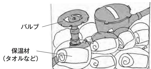
ら溶かしてください。急に熱湯をかけると、水道管や蛇口が破裂する場合があります。
